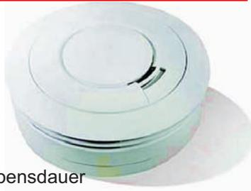
> Rauchwarnmelder der Serie Ei650 arbeiten nach dem foto-optischen Prinzip / Streulicht-Prinzip. Er löst Alarm aus, sobald Rauch in die optische Rauchkammer eingedrungen ist. Das eingebaute, piezo-elektronische Horn alarmiert mit einem Schalldruck von mind. 85dB(A) in drei Metern Entfernung. Sobald keine Rauchpartikel mehr in der Rauchkammer vorhanden sind, wird der Rauchwarnmelder automatisch zurückgesetzt und der Alarm ausgeschaltet.
